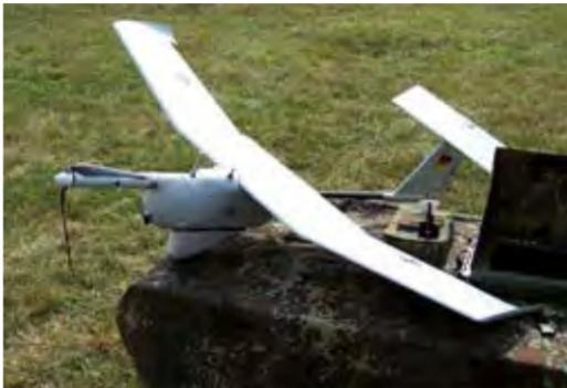
ALADIN (abbildende luftgestützte Aufklärungsdrohne im Nächstbereich) wird durch einen Elektromotor angetrieben und liefert echtzeitnahe Aufklärungsergebnisse aus dem Nächstbereich mittels abbildender Sensoren.
