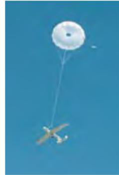
LUNA (Luftgestützte Unbemannte Nahaufklärung – Ausstattung) ist ein propellergetriebenes leichtes Drohnensystem, welches für die Echtzeit-Luftaufklärung und –Überwachung eingesetzt wird. Der Start erfolgt mit einem Startkatapult. Die Landung erfolgt in einem Landenetz oder am Fallschirm.
