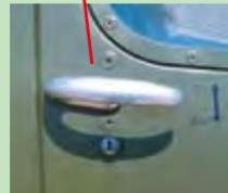
Die Cockpittüren rechts und links lassen sich durch Drehen des Türgriffes in die OPEN-Position öffnen.
