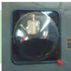
Die Fenster an der Rumpfseite werden durch Ziehen an der roten Lasche aus dem Rahmen gelöst. Die gewölbte Scheibe lässt sich ebenfalls so lösen.
