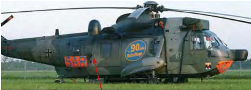
Die Schiebetür befindet sich auf der rechten Seite hinter der Fahrwerks gondel.
