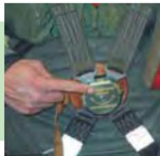
Der Bordmechaniker kann in einem Stehhaltgurt oder mit der Modularen Rettungsweste am Luftfahrzeug befestigt sein. Zum Lösen des Stehhaltgurtes die Sicherungsfeder an der gelben Lasche abziehen, den Drehknopf um 90° drehen und auf den Drehknopf drücken.
