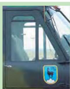
Die beiden Cockpittüren rechts und links werden mit dem Türgriff geöffnet.
