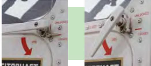
Den Griff an der Cockpittür mit dem kleinen Hebel entriegeln ( von LOCK auf UNLOCK ), dann nach unten drücken (OPEN).
