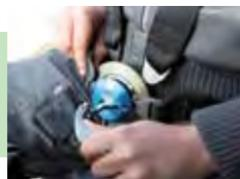
Die Fünf-Punkte-Gurte der Piloten werden mit einem Zug an der Lasche vom Körper weg gelöst.
