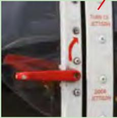
Der Notabwurf der Cockpittüren befindet sich jeweils zwischen den Scharnieren. Dazu den roten Hebel auf TURN TO JETTISON drehen.
