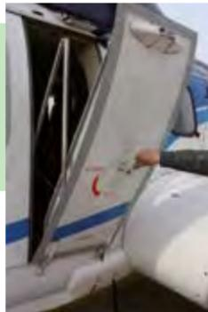
Auf der linken Seite steht eine aufklappbare Eingangstür zur Verfügung. Türgriff eindrücken und in Richtung OPEN drehen. Die Tür klappt nach außen auf.
