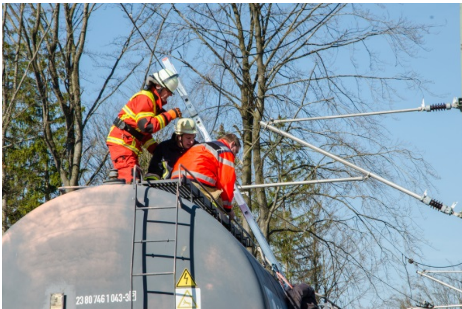
Abbildung 59: Absturzgefahr besteht in den Dachbereichen von Eisenbahnfahrzeugen
