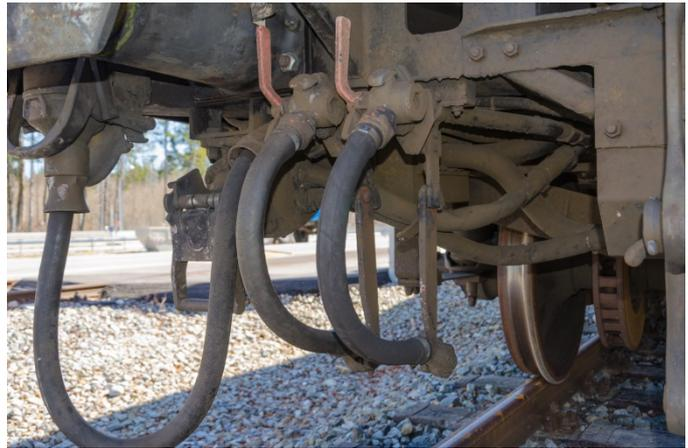
Abbildung 35: Luftleitungen mit Luftabsperrhähnen
