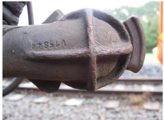
Abbildung 36: Gekennzeichneter Luftkopf einer Hauptluftbehälterleitung
