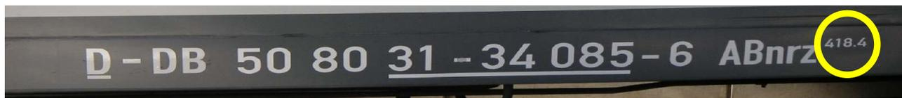
Abbildung 29: Zwölfstellige Fahrzeugnummer mit Bauartnummer
