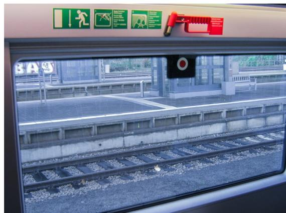
Abbildung 45: Kennzeichnung Notausstiegswindern
