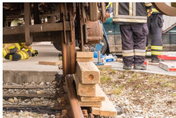
Abbildung 43: Sichern eines angehobenen Fahrzeugs durch Unterbau
