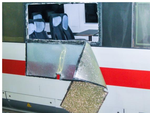
Abbildung 46: Notausstiegswindern lassen sich nach außen wegdrücken
