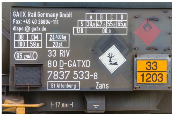
Abbildung 34: Anschriftentafel bei Kesselwagen mit Lastgrenzenraster und orangefarbener Kennzeichnung
