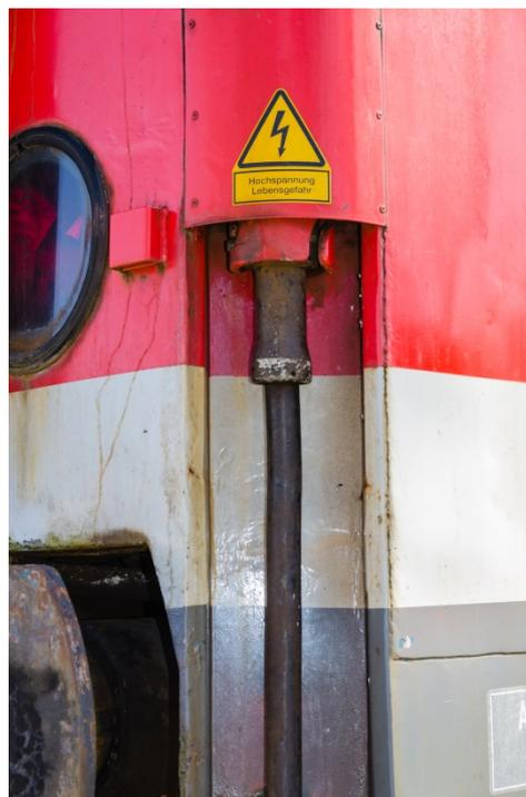
Abbildung 37: Nicht verbundene Zugsammelschiene an einem Reisezugwagen
