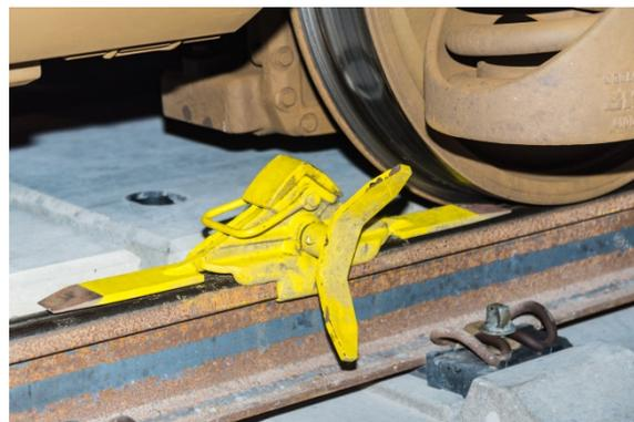
Abbildung 41: Radvorleger werden auf der Schiene befestigt
