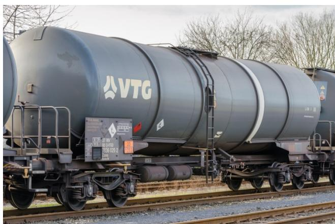
Abbildung 27: Kesselwagen für flüssige Stoffe
