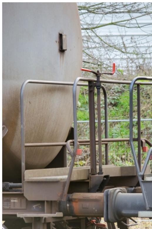
Abbildung 39: Feststellbremseinrichtungen auf der Pufferbrücke
