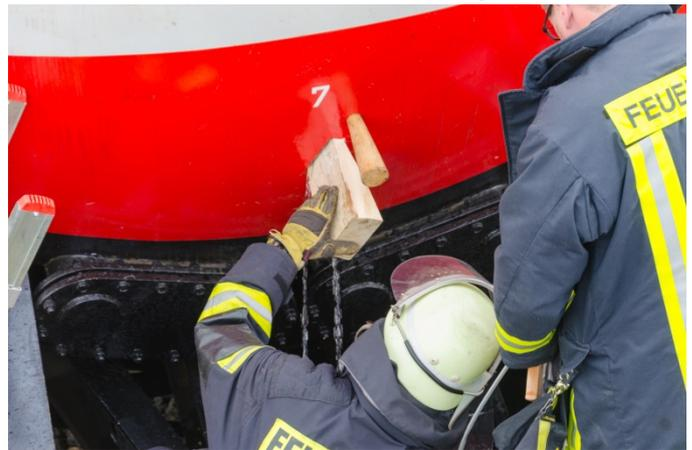
Abbildung 19: Abdichten eines Risses im Kessel
