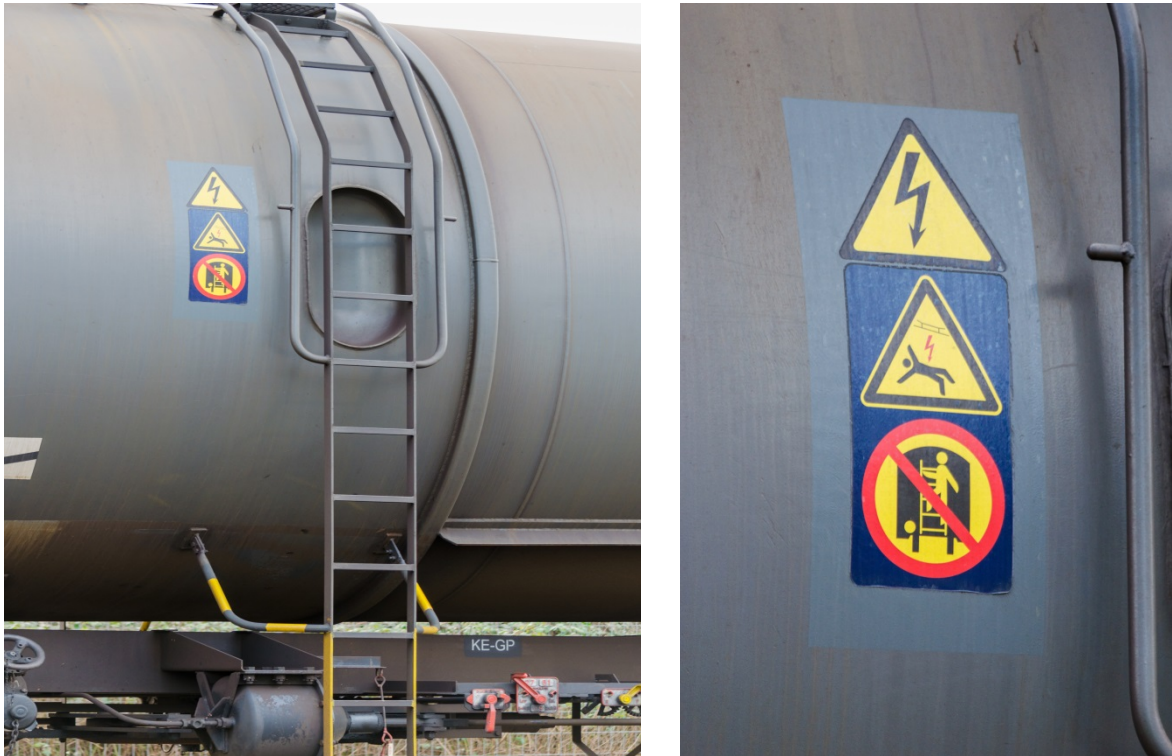
Abbildung 4: Warnhinweis Oberleitung an Fahrzeugen
